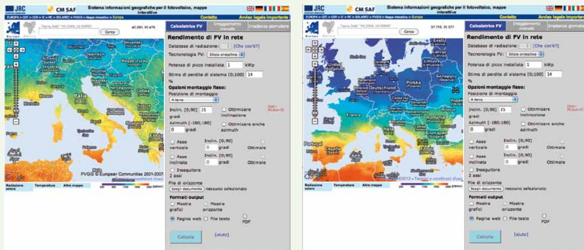
Videata italiana ed europea di PVGIS, uno strumento per il calcolo dell'irraggiamento solare in un determinato sito, in base alla sua ubicazione geografica. © Unione europea, 1995-2012
