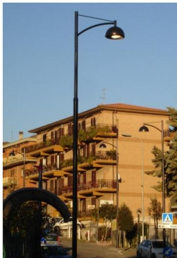
**Figura 6.23 - palo con sbraccio ed armatura cut off**
