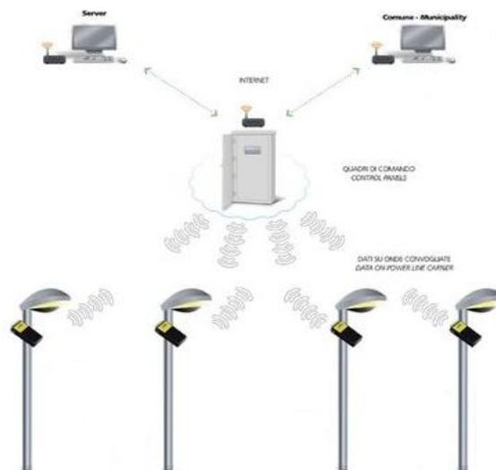
Figura 6.27: Sistema di telecontrollo e gestione energetica
